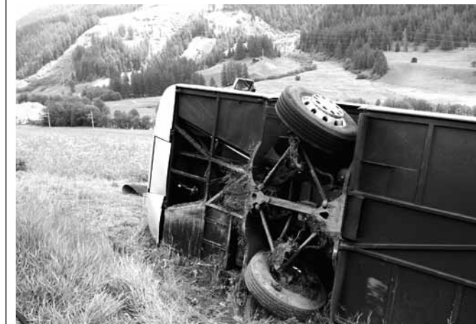
Car mit eingeschlagenen Vorderrädern: Der Car war mit dem rechten Vorderrad auf den Grasrand geraten und der Fahrer hatte versucht, den Car wieder zurück auf die Strasse zu lenken.
