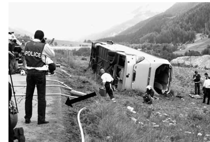
Tückischer Seitenrand der Kantonsstrasse: Der schnell abfallende Seitenrand aus mehreren Asphaltschichten verhinderte, dass der Bus-Chauffeur das Vorderrad wieder auf den Asphalt zurücklenken konnte (siehe Pfeil).
